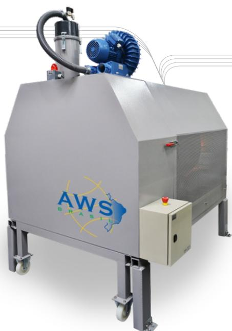
Uma tecnologia por irradiação infravermelha aquece o material a partir do núcleo, gerando uma eficiência de secagem e cristalização com relação a tempo de secagem e consumo de energia. Indicado para secagem e cristalização de plásticos como ABS/PC, PC/LCP compostos com madeira, PET, PPS, PLA entre outros. Pré-aquecimentos de materiais para otimizar processos de extrusão como PVC e PE.
